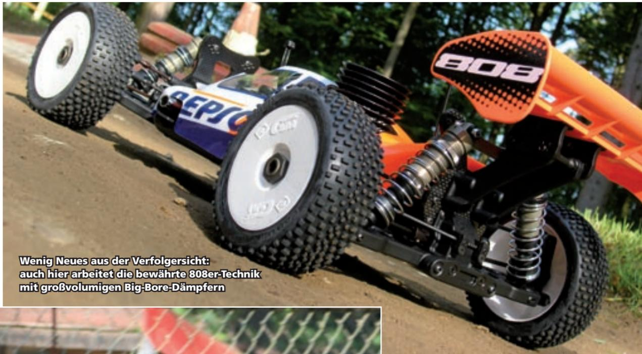
Wenig Neues aus der Verfolgersicht: auch hier arbeitet die bewährte 808er-Technik mit großvolumigen Big-Bore-Dämpfern
