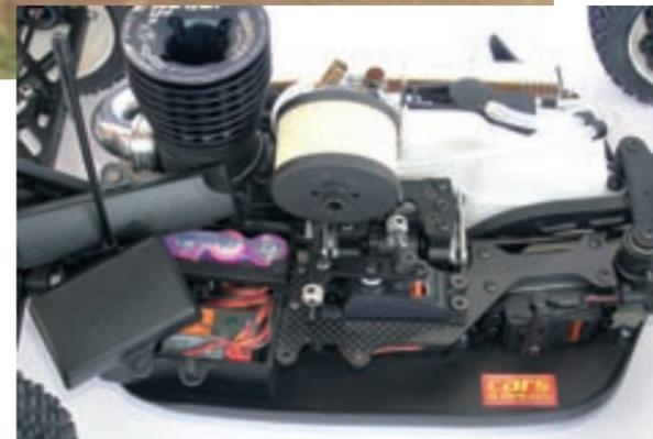
Einerseits rückte die RC-Box etwas weiter vom Motor weg und andererseits schmiegen sich die beiden Servos aufgrund der geänderten RC-Platte nun etwas näher an den Antriebsstrang
