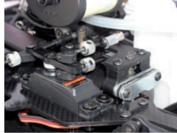
Entgegen dem liegend eingebauten Lenkservo verrichtet das Gasservo seine Arbeit im Stehen. Neben den klassischen Einstellmöglichkeiten der beiden Bremsscheiben setzt man nun bei Halter und Verstrebung auf gewichtssparendes Kunststoffmaterial
