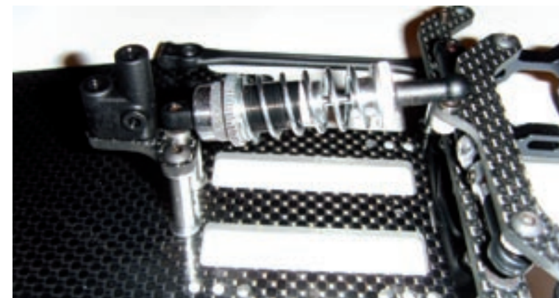
Der zentrale Dämpfer erhielt eine andere Feder
