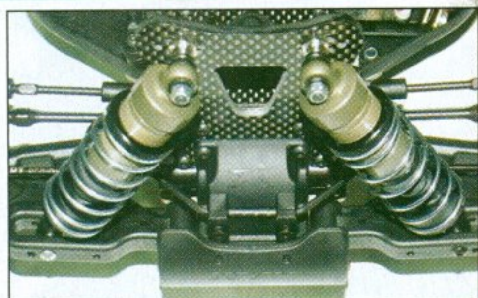
Particolari ammortizzatori anteriori.
