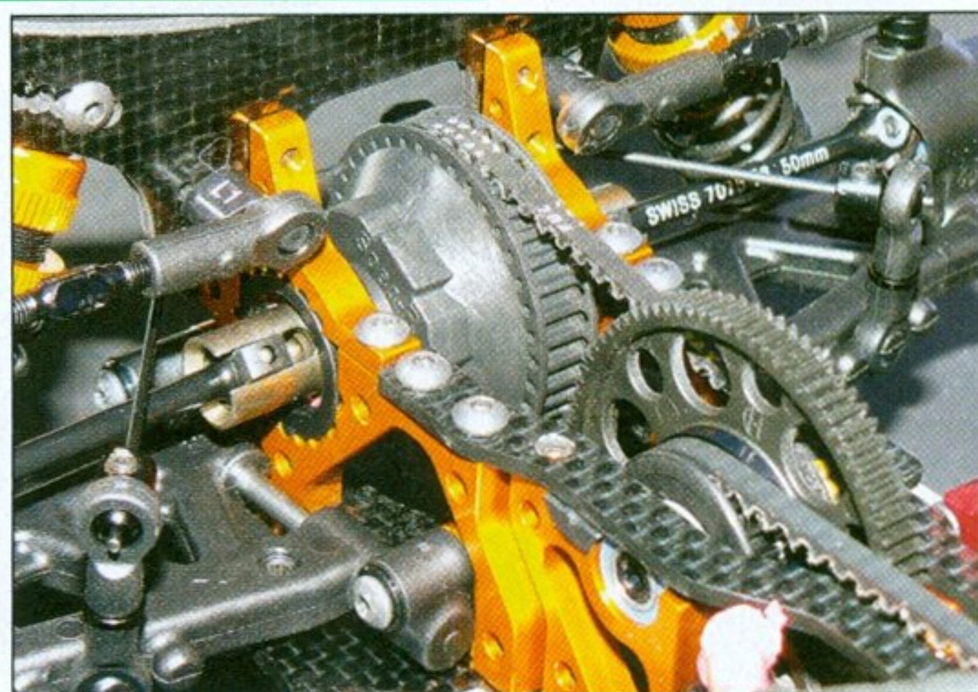
Il differenziale a ingranaggi portato in gara a Palazzolo.
