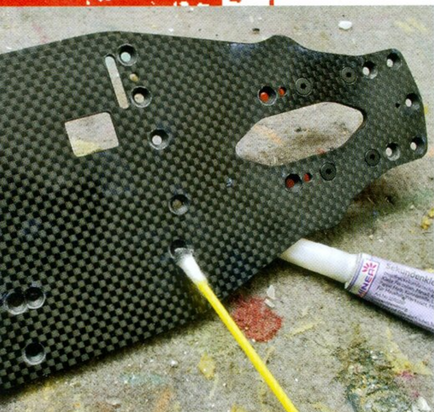
Die Chassiskanten werden mit Sekundenkleber und Wattestab versiegelt
