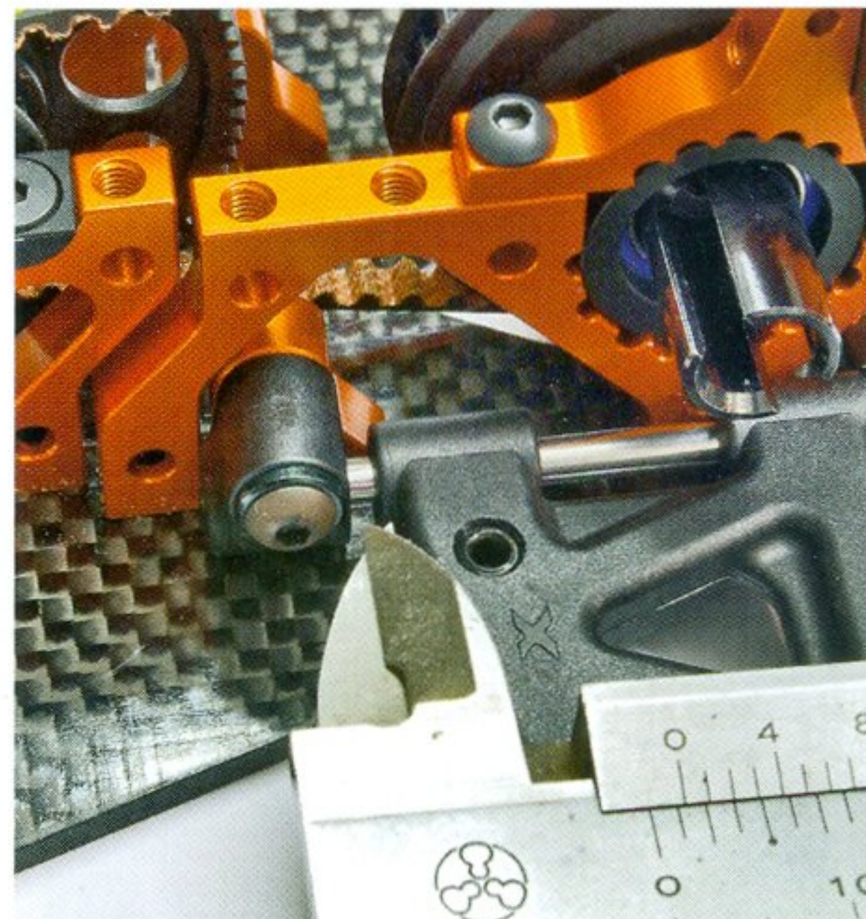
Hier kommt eine in der Dicke reduzierte Unterlegscheibe zum Einsatz
