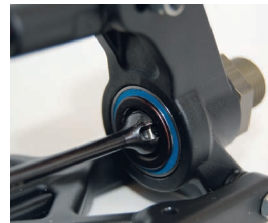
Fans der Marke erkennen die typischen XRAY-Kugellager mit blauen Dichtscheiben
