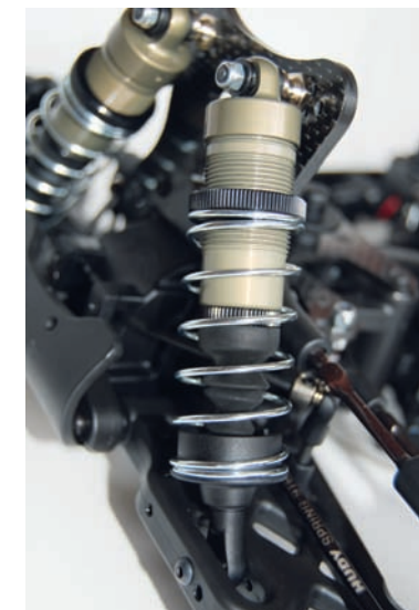
Die aktuellen Bigbore-Stoßdämpfer verfügen neben einer Rändelverstellung auch über Faltenbälge zum Schutz vor Dreck und Schlamm
