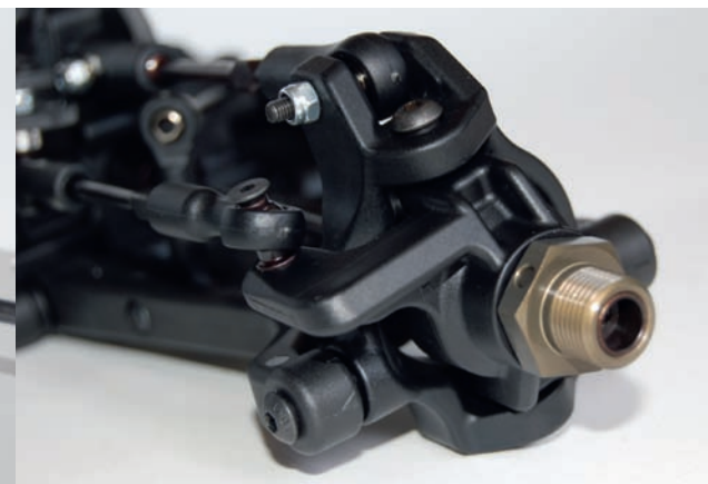
Die C-Hub-Konstruktion der Lenkung sorgt für optimale Lenkausschläge
