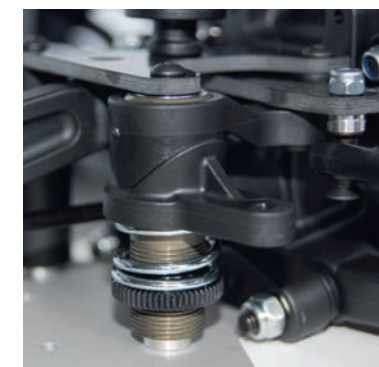
Bei harten Schlägen schützt der einstellbare Servosaver die Lenkmechanik und das Servo
