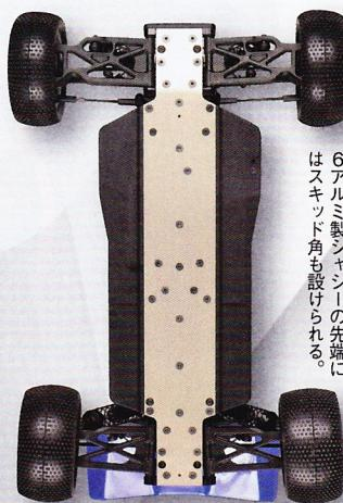
アルミ製フレームと樹脂バスタブを組み合わせたメインシャシーを採用。7075T6アルミ製シャシーの先端にはスキッド角も設けられる。
