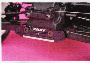
カーボンプレート製のアップデッキはスパーギヤの直後までというユニークなデザイン。バッテリーの着脱が容易になっている。
