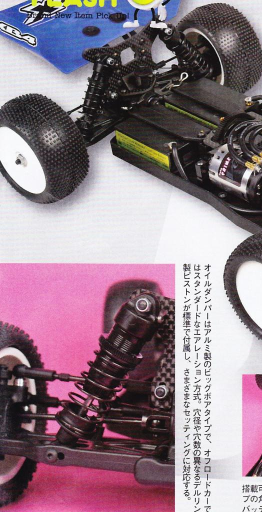
オイルダンパーはアルミ製のビッグボアタイプで、オフロードカーではスタンダードなエアレーシング方式。穴径や穴数の異なるデルリン製ピストンが標準で付属し、さまざまなセッティングに対応する。
