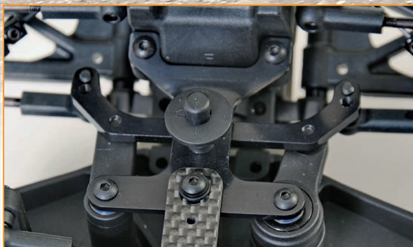
El sistema de dirección ahora está formado por una nueva placa superior y ackerman, ambos de aluminio.
